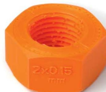
Als einzige Maschine versah der Ultimaker die gedruckte M20-Mutter mit einer lesbaren Beschriftung.
