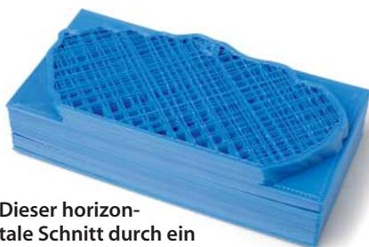
Dieser horizontale Schnitt durch ein halb gedrucktes Objekt zeigt das von der Software generierte Gittermuster im Inneren.
