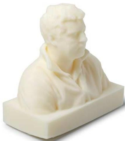
Diese Porträtbüste ist dem Replicator leider nicht ganz standfest gelungen – schuld ist das Material: Wenn ABS abkühlt, treten im gedruckten Objekt enorme Spannungen auf.
